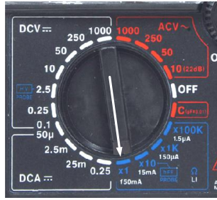
รูปที่ 2.11 แสดงการตั้งย่านวัดความต้านทาน R x 1
